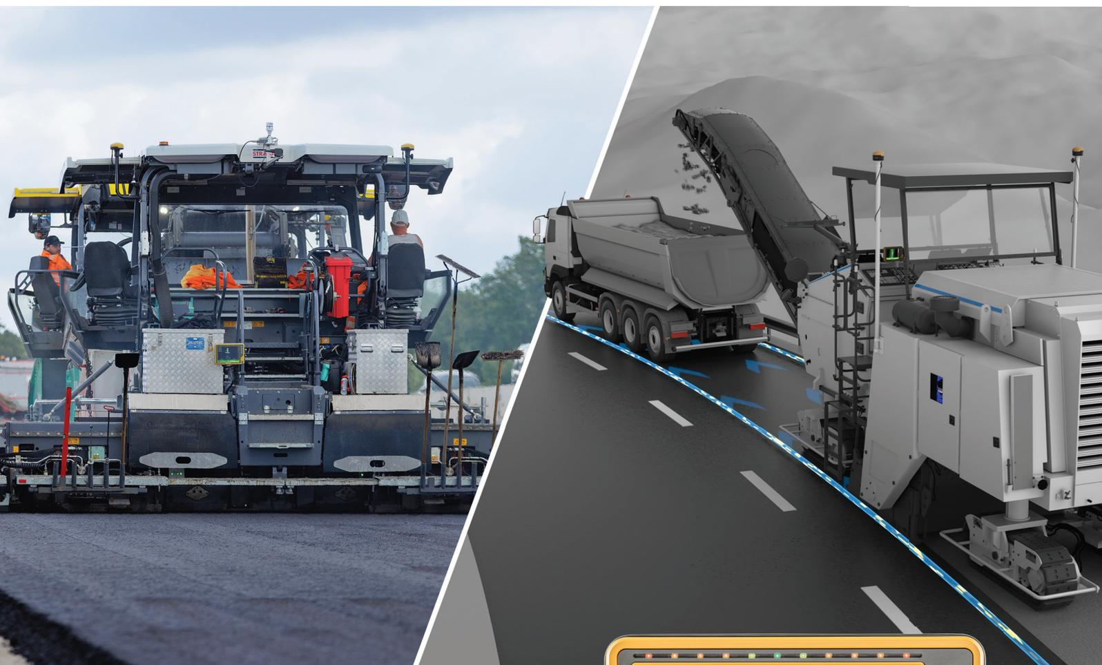
Grazie al controllo 3D a spessore variabile, l'RD-MC è la soluzione più versatile per la fresatura nella ripavimentazione stradale.
