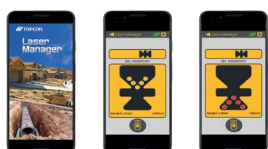
Application mobile Laser Manager : commande et affichage à distance
