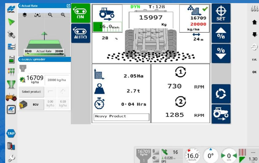
Horizon OS / ISOBUS - Guidance / Exemple de contrôle de l'épandage
