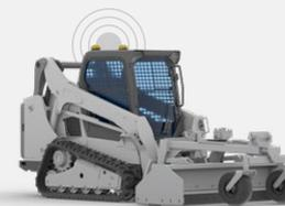
3D Anzeigesystem zur Positionierung von Schaufeln und Vorsatzrädern
