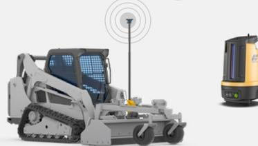
Automatische Steuerung bestimmter Anbaugeräte mit horizontaler und vertikaler Position
