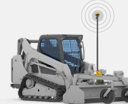
Automatische Steuerung bestimmter Anbaugeräte mit horizontaler und vertikaler Position
