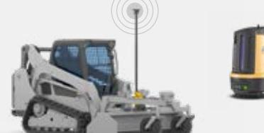
Controle automáticamente accesorios específicos con posición horizontal y vertical
