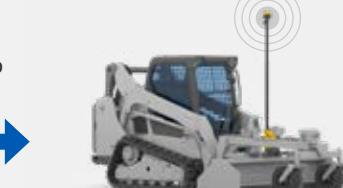
Posicionamiento 3D de indicación para cucharones y palas PAT (bulldozer)
