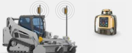
Control automático de elevación y pendiente para accesorios específicos
